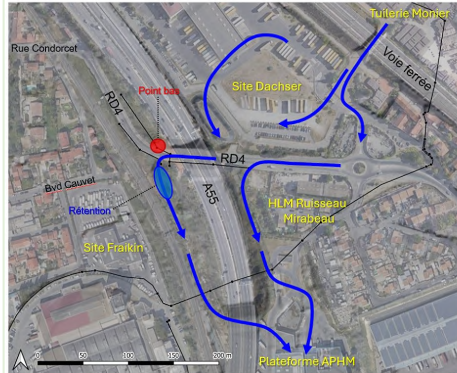
Figure 25. Fonctionnement hydraulique en situation actuelle (Source : SETEC)
