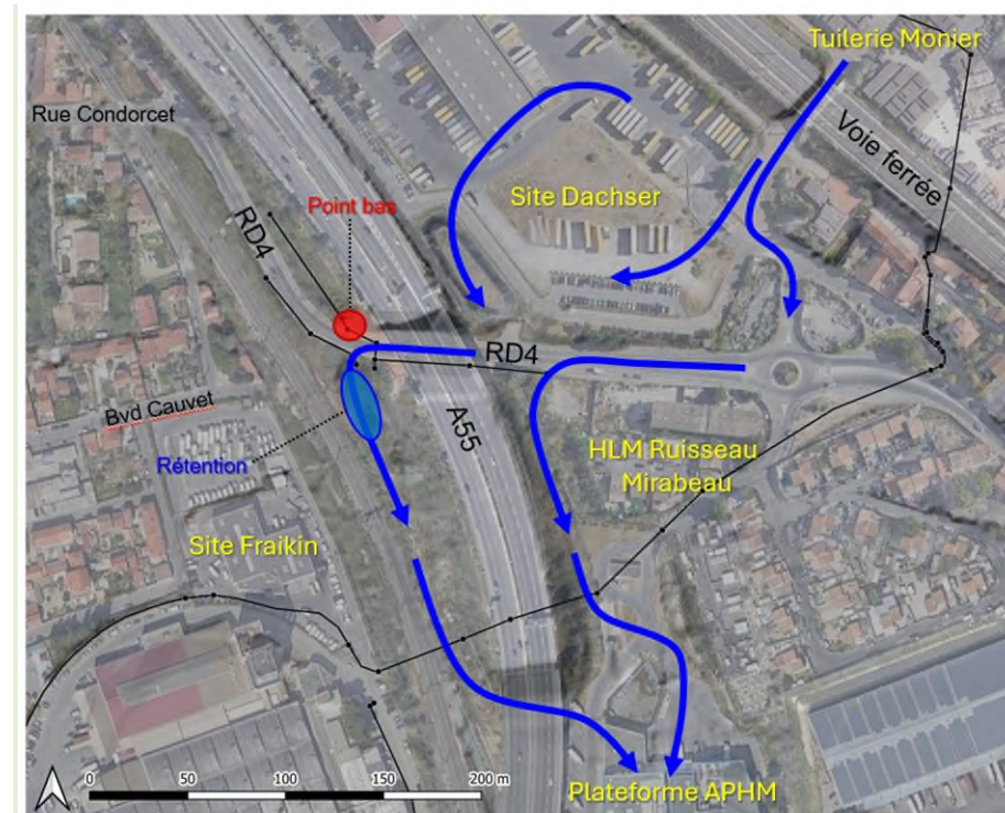
Figure 3. Fonctionnement hydraulique en situation actuelle (Source : SETEC)
