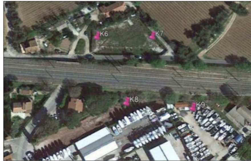
Figure 25 : Localisation des essais de perméabilité Matsuo (Source : AVP, 2024)
