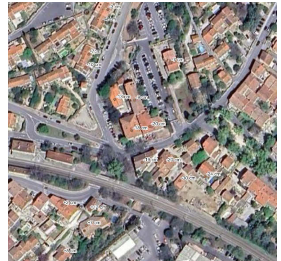
Figure 54: Variations des hauteurs d'eau pour toutes les habitations concernées, avant mesures de correction
