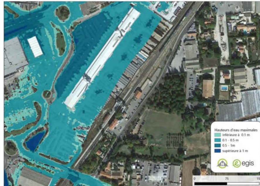
Figure 62 : Carte des hauteurs d'eaux maximales pour une crue centennale dans le secteur de la gare La Pauline - état projet (source : Etude du risque d'inondation de l'opération La Pauline – Egis, 2024)
