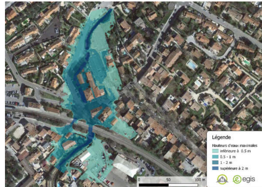
Figure 48: Carte des hauteurs maximales sur le Dégoutant
