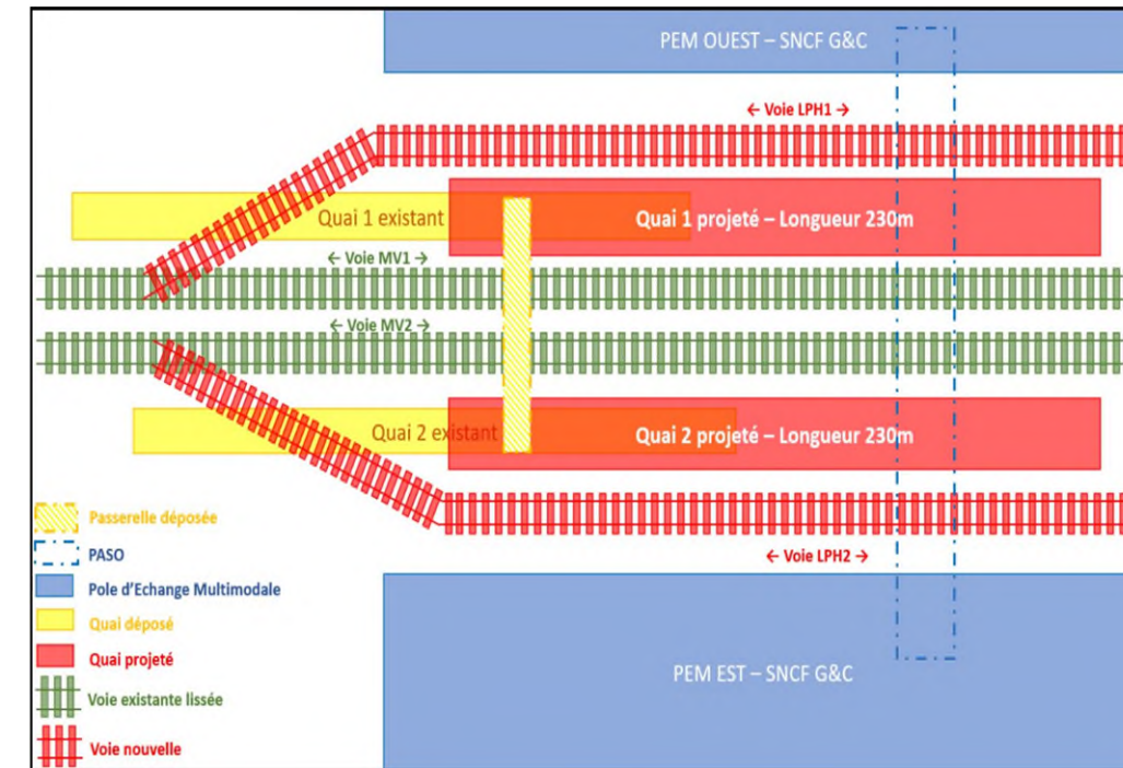
Figure 47 : plan de voies en gare de La Pauline (Source d'après études AVP, 2024)
