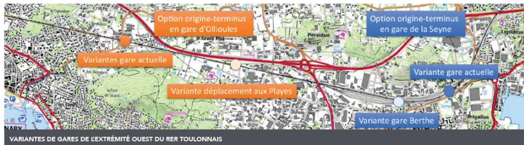
Figure 97 : Variantes de localisation du terminus ouest de la navette toulonnaise discutées lors de la concertation de 2019
