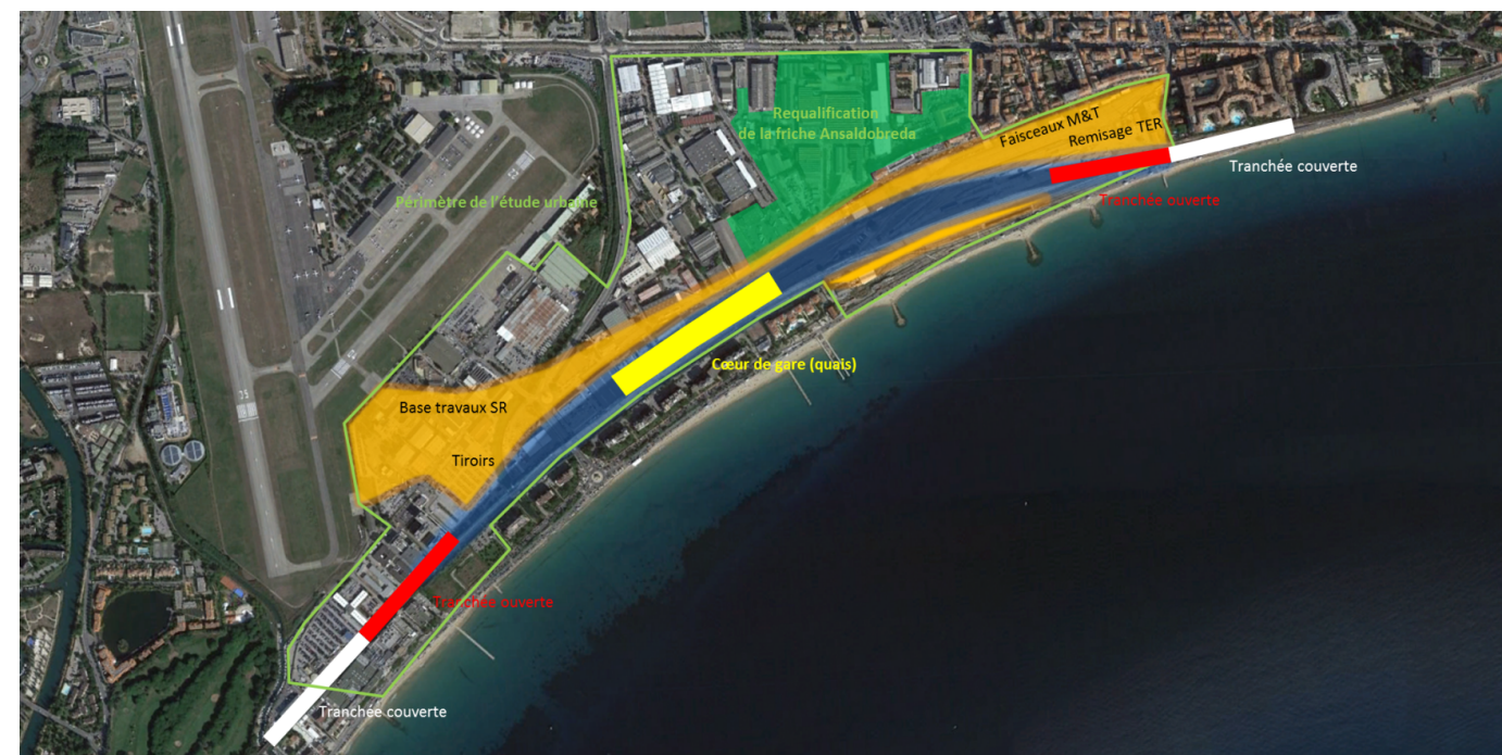
Figure 92 : Esquisse d'insertion de la future gare TGV dans le site de Cannes Marchandise (SNCF R) En orange, emprises envisagées pour le rétablissement des fonctionnalités ferroviaires du site actuel.
