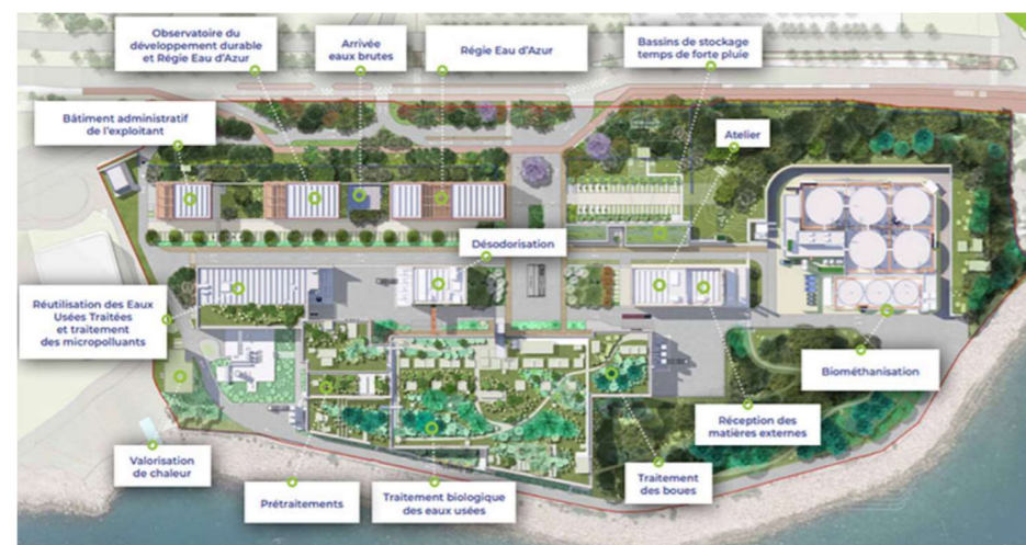
Figure 21 : Schéma de l'extension Haliotis II
