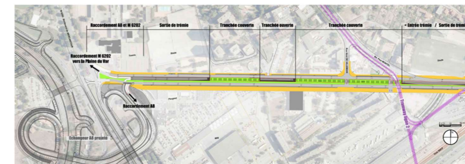
Figure 15 : Projet de réalisation du tunnel de la Victorine (aménagement de la sortie ouest - phase 2)
