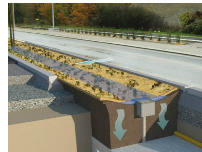
Figure 22 : : Principe d'une noue (source : OFCP)
