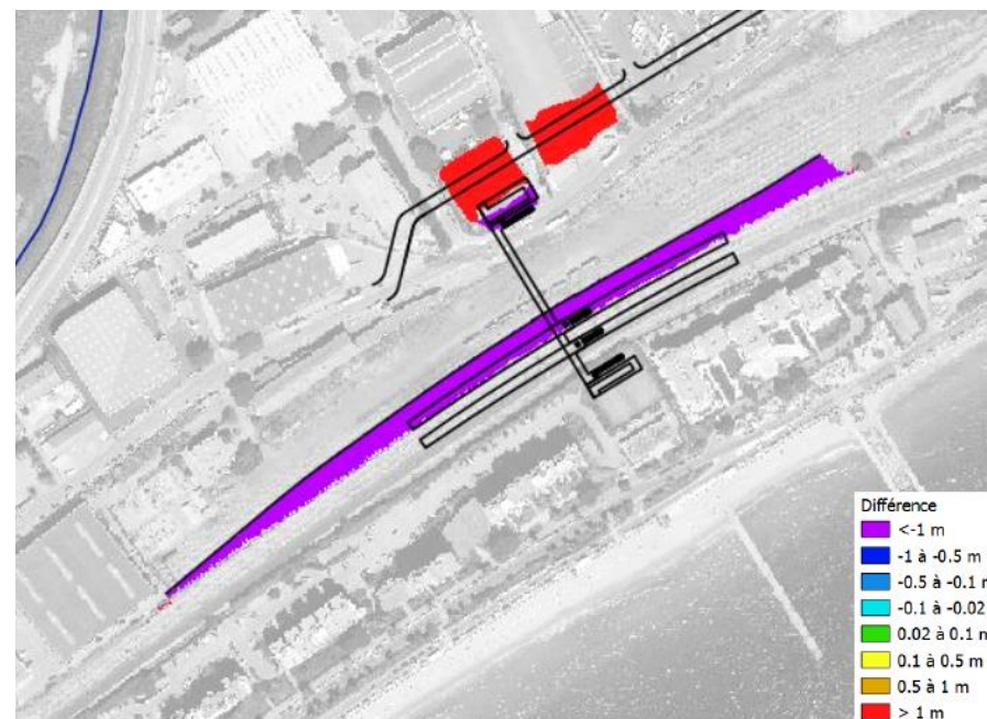
Figure 15 : Exemple d'analyse des impacts à partir d'une modélisation hydraulique bi-dimensionnelle (impact en niveaux d'eau = niveau d'eau à l'état projet moins le niveau d'eau à l'état initial)
