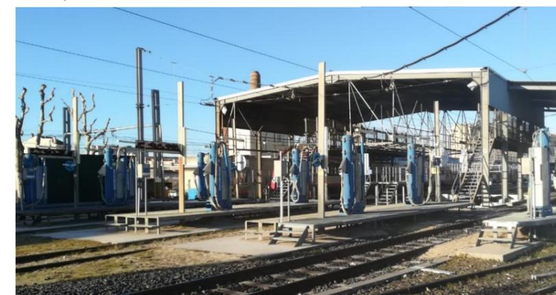
Figure 2 : Machine à laver au défilement (études de recalage, 2019)
