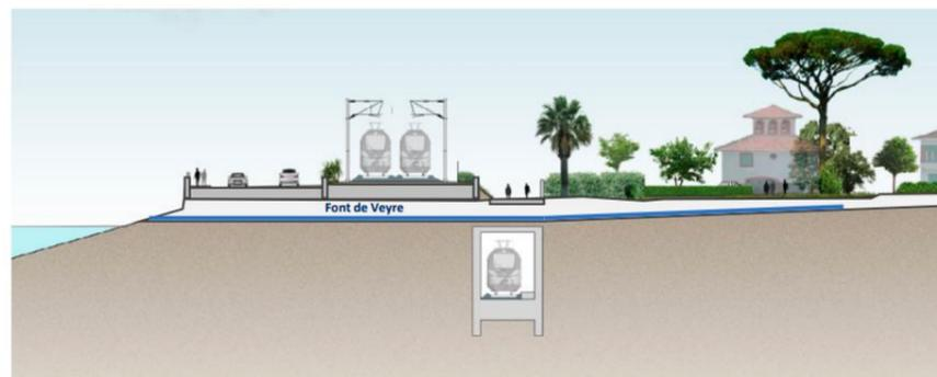
Figure 7 : coupe du passage en terrier sous le Font de Veyre (Systra, 2021)
